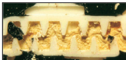
Figura 5. Gotero con precipitado de calcio. Las piezas negras en el cuadro son piezas de la línea de goteo de plástico recortadas y no contaminantes
